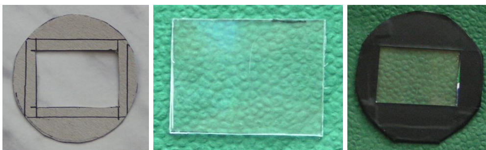
Fig. 6: elementi del reticolo di diffrazione e reticolo di diffrazione pronto per l'uso
